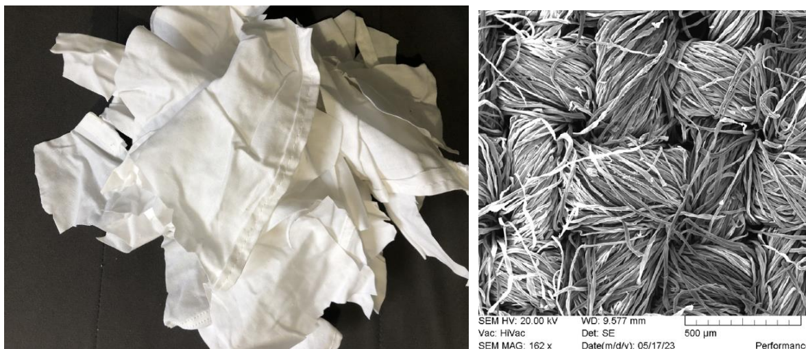
Фиг. 4. Отпадъчен памучен текстил и SEM изображение
